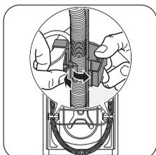
Отсоедините сетевой шнур и шланги от разъемов на задней панели стиральной машины.
