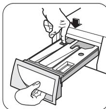
Извлеките дозатор, отжав вниз защелку и потянув его на себя. Промойте его под краном, чтобы удалить все остатки скопившегося в нем порошка.
