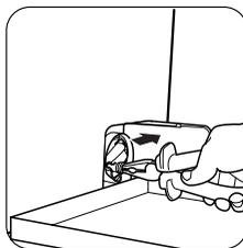
С помощью плоскогубцев выньте заглушку отверстия аварийного слива из крышки фильтра.
