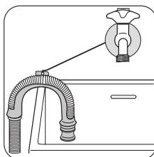
Подвесить над краем раковины, используя пластмассовую направляющую, входящую в комплект поставки машины.
