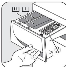
Ш Отделение для порошкового или жидкого моющего средства, используемого при основной стирке. При использовании жидкого моющего средства наливайте его **непосредственно перед** запуском программы.
