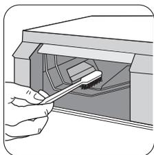
После снятия дозатора с помощью маленькой щетки прочистите отсек, в котором он находился, тщательно удалив все остатки моющих средств из его верхней и нижней части.
