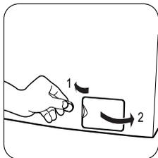
Откройте дверцу насоса, вставив в паз монету (или специальный инструмент, который может находиться в пакете с руководством по эксплуатации - в зависимости от модели).
